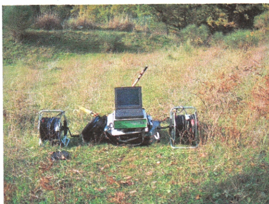
Sismografo 24 canali Ambrogeo mod. Echo 24/2002 Seismic UNIT.
